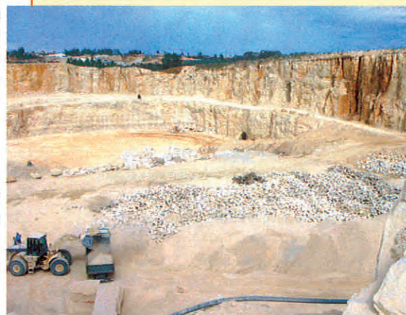
Extraction et sélection de roches calcaires, matières premières de la chaux.
